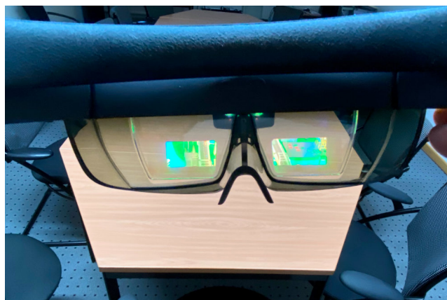
Abbildung 2: Die Anwendung "Smart City: Clean Energy" (Ong Innovations, 2018) auf der Microsoft HoloLens. Für den Betrachter wird die Stadt auf einer beliebigen Oberfläche dargestellt.
